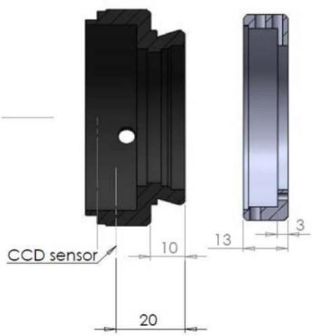
Длина бэкфокуса QHY8PRO составляет 20 мм, как показано без центра и кольца регулировки угла. Если вы подключите кольцо регулировки наклона и смещения, то заднее расстояние - бэкфокус увеличится примерно на 3 мм.
