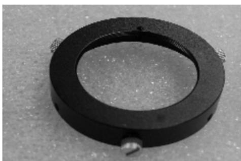
Кольцо регулировки наклона
