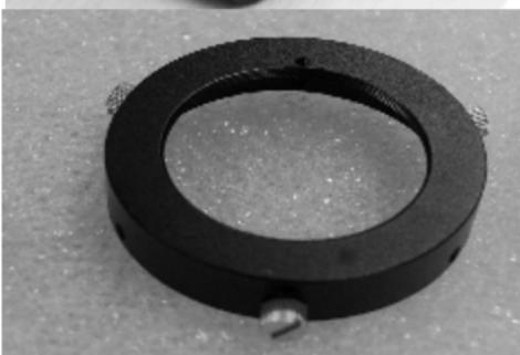
Кольцо регулировки наклона
