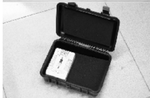
Специальный бокс с электроподогревом для прокаливания силикагеля
